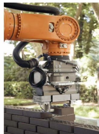
Obr.8 R/O/B/- robot pro zidání (Pike St.NYC, USA)
