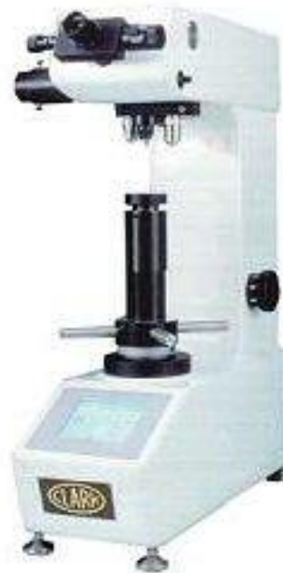
Slika 14. Uređaj za utiskivanje dijamantne piramide po Vickersu
